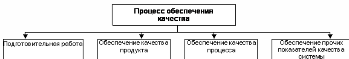
Рис. 2.9. Схема процесса обеспечения качества
